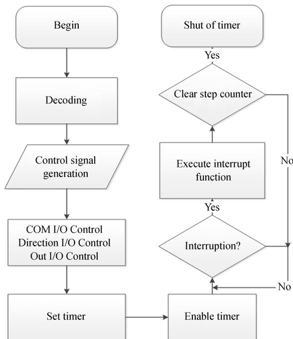
图 3 电机信号生成模块软件流程
