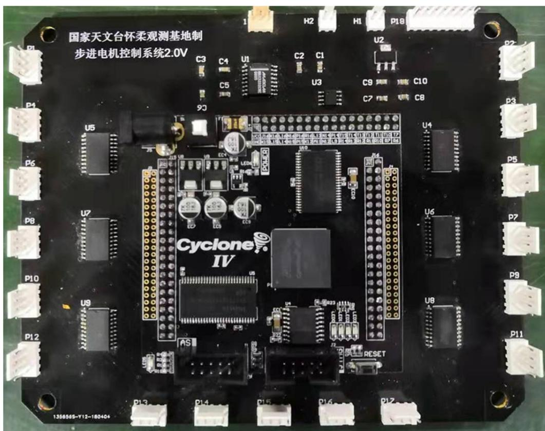
图 2 步进电机控制器
